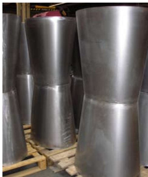
Plaatwerk van tafelpoot, gelast
